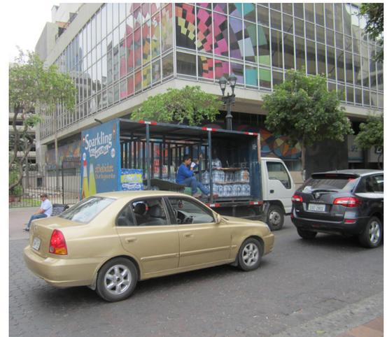
Operario en un vehículo de carga en circulación sin sujeciones, con riesgo de caída en caso de frenado brusco.
