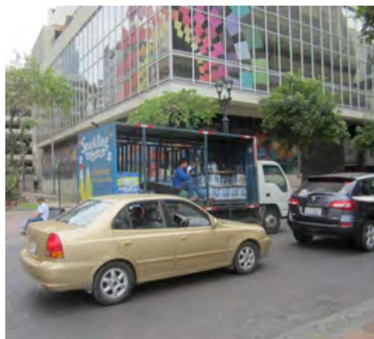
Operario en un vehículo de carga en circulación sin sujeciones, con riesgo de caída en caso de frenado brusco.
