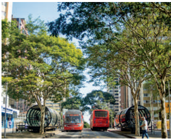
“Convertir el autobús en un metro” con estaciones especialmente diseñadas que permiten embarque y prepago en el mismo mismo nivel, vías exclusivas para autobuses, trayectos cortos y vehículos de mayor capacidad (hasta 270 pasajeros por autobús de doble articulación). Primera foto de Arthur Cordeiro, segunda foto de Lina Faria, dibujo a mano de Jaime Lerner. Archivos del Instituto Jaime Lerner.
