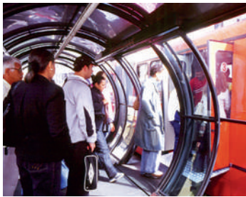
“Convertir el autobús en un metro” con estaciones especialmente diseñadas que permiten embarque y prepago en el mismo mismo nivel, vías exclusivas para autobuses, trayectos cortos y vehículos de mayor capacidad (hasta 270 pasajeros por autobús de doble articulación). Primera foto de Arthur Cordeiro, segunda foto de Lina Faria, dibujo a mano de Jaime Lerner. Archivos del Instituto Jaime Lerner.
